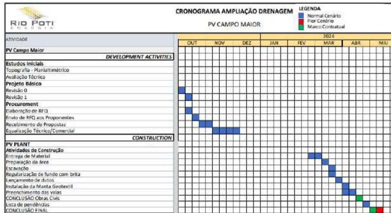
Figura 2 - Cronograma de Ampliação de Drenagem
