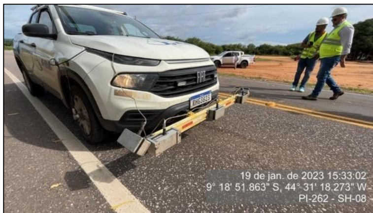
Figura 144 – Veículo com os equipamentos acoplados para Ensaio de IRI e ATR
