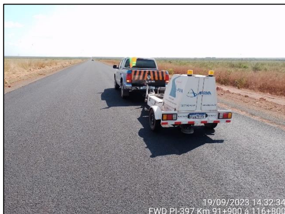
Figura 1 - Ensaio FWD (set/23) - Pavimento sem pintura - SH-03
