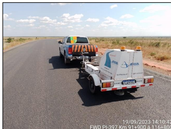
Figura 2 - Ensaio FWD (set/23) - Pavimento sem pintura - SH-03
