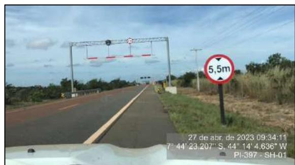
Figura 28 - Pórtico de detecção de altura da P1 - SH-01
