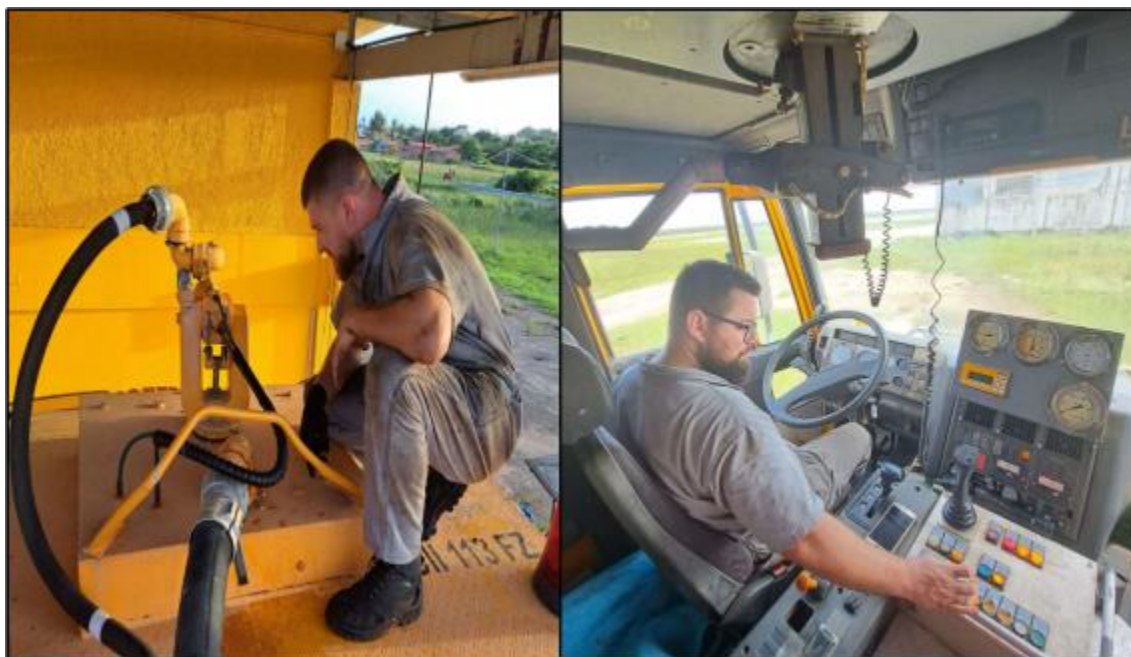
Figura 65. Teste operacional do canhão monitor
