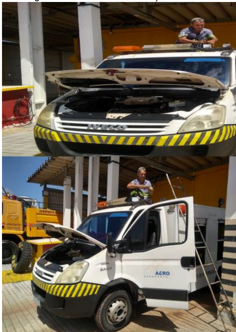
Figura 66. Troca de alarme e iluminação intermitente
