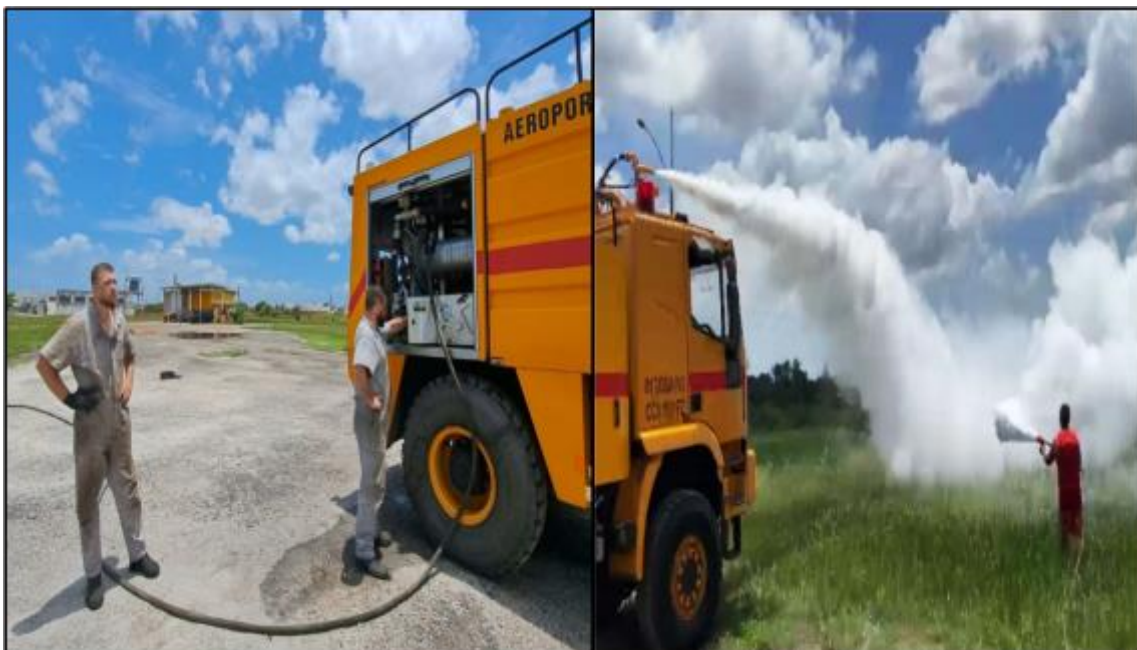
Figura 63. Teste operacional do sistema de PQ
