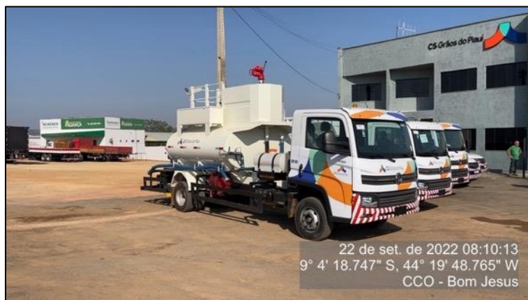
Figura 146 - Caminhão pipa dotado de sistema de combate a incêndio
