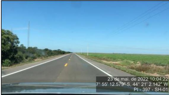
Figura 27 – Trecho sem dispositivos de drenagem – SH-01
