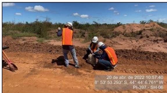
Figura 20 – Coleta de solo no Segmento 06
