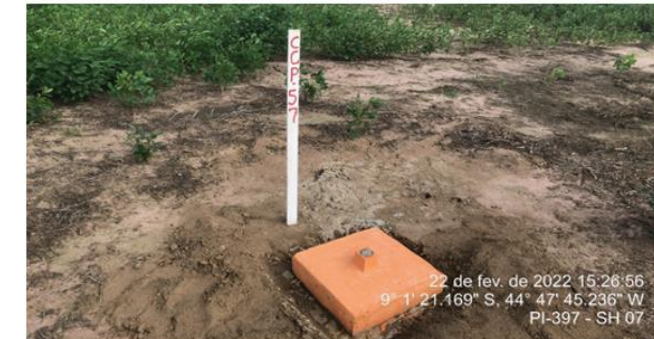
Marco topográfico implantado pela concessionária.
