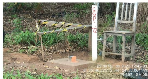
Marco topográfico implantado pela concessionária.
