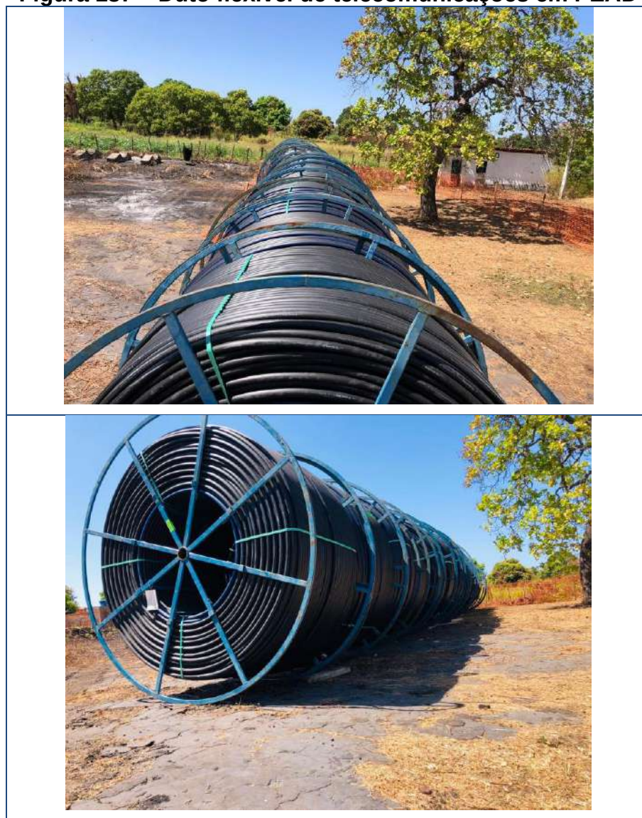
Figura 187 – Duto flexível de telecomunicações em PEAD
